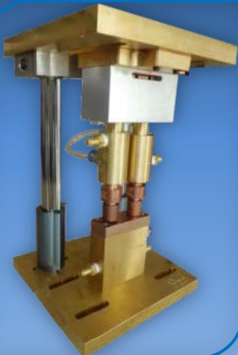
**Dispositivo equalizante mecânico** para processos de alto rendimento podendo ser para ponto ou projeção sendo indicado para distancias entre centro médias, esse dispositivo tem a melhoria comparado ao hidráulico que não há necessidade de shunt, pois a transmissão de energia é pelo próprio compensador, as guias do mesmo são autolubrificantes de polímeros não necessitando lubrificação.
