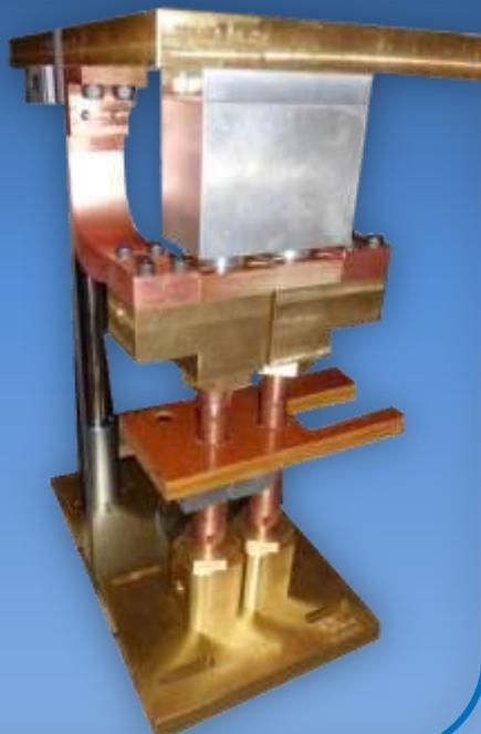
**Dispositivo equalizante hidráulico** para processos de alto rendimento, sendo o sistema de equalização confeccionado com camisas de duralumínio anodizado com a mesma tecnologia de fabricação de cilindros, esse dispositivo pode ser usado para solda de 2 peças diferentes ganhando tempo de ciclo, sendo recomendado para distancias entre centros grandes.
