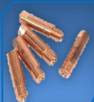
**Eletrodos e Porta eletrodos diversos:** Para solda a ponto e por projeção, fabricados em ligas especiais de Cobre, tais como Cobre Cromo Zircônio (CuCrZr), Cobre Cromo (CuCr), Cobre Cobalto Berílio (CuCoBe), Cobre Zircônio (CuZr) e outros.
