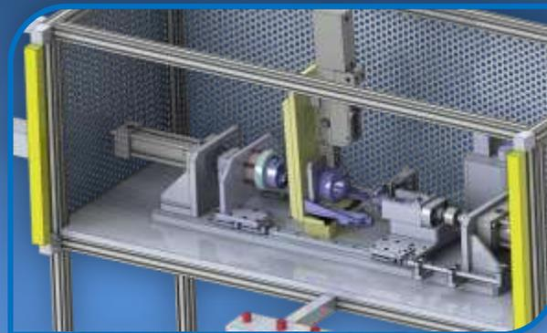
**Dispositivo de montagem hidráulico** com sistema de patins de esferas para perfeito alinhamento de montagem, e com célula de carga + régua potenciométrica para garantir o posicionamento final.
