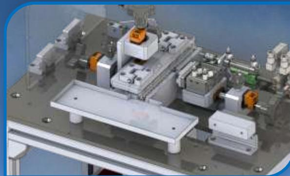
***Dispositivo de calibrar** para produtos que tem variação no processo, passam por este equipamento para fazer a calibração, todo sistema pneumático e com regulagens em décimos e sistema de setup sem precisar apertar parafuso nenhum, toda regulagem com manípulos e fusos.*
