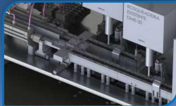
**Dispositivo de rosqueamento** com alimentação automática, e sendo as rosqueadeiras independentes e com controle de quebra de macho, para garantir que nenhum produto passe sem o rosqueamento efetuado.
