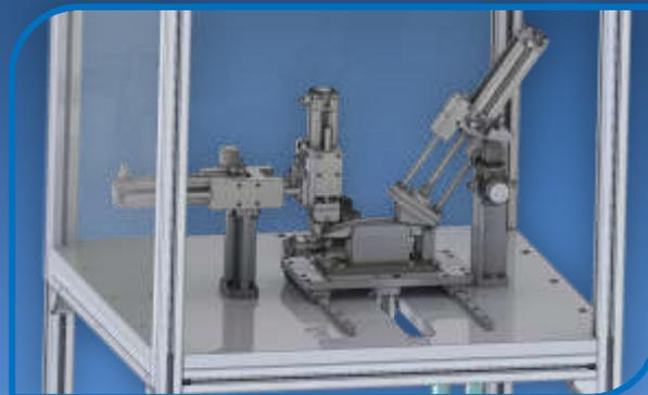
**Dispositivo de aplicar adesivo** com regulagem de pressão para deixar toda a superfície homogênea, com sistema de carro para o operador poder abastecer, para não haver necessidade de cortina de luz.
